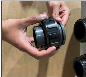
Eine der Manschetten auf einem der Einsätze anbringen.
