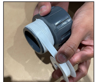
Schraubfiting für das MPV nehmen. Gewinde mehrmals im Uhrzeigersinn mit PTFE-Band umwickeln, um wasserdichte Verbindung zu gewährleisten.
