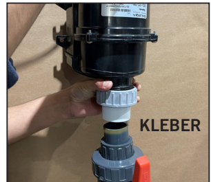
Gebläseverschraubung auf Gebläse aufschrauben. NUR HANDFEST ANZIEHEN. Dann das Rohr außen und die Gebläseverschraubung innen säubern und mit Kleber bestreichen, dann zusammenschieben.
