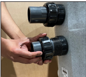
Den anderen Einsatz nehmen und die Manschette darauf anbringen.
