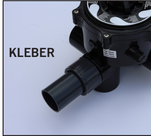
MPV-Anschluss innen und das 9 cm Rohr außen säubern und mit Kleber bestreichen, dann zusammenschieben.
