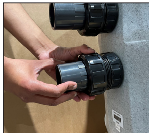
Manschette auf den Einlass schrauben. NUR HANDFEST ANZIEHEN.
