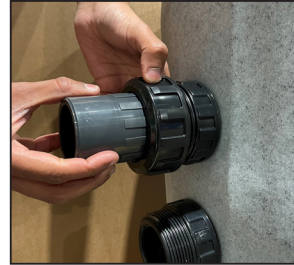
Manschette auf den Auslass schrauben. NUR HANDFEST ANZIEHEN.
